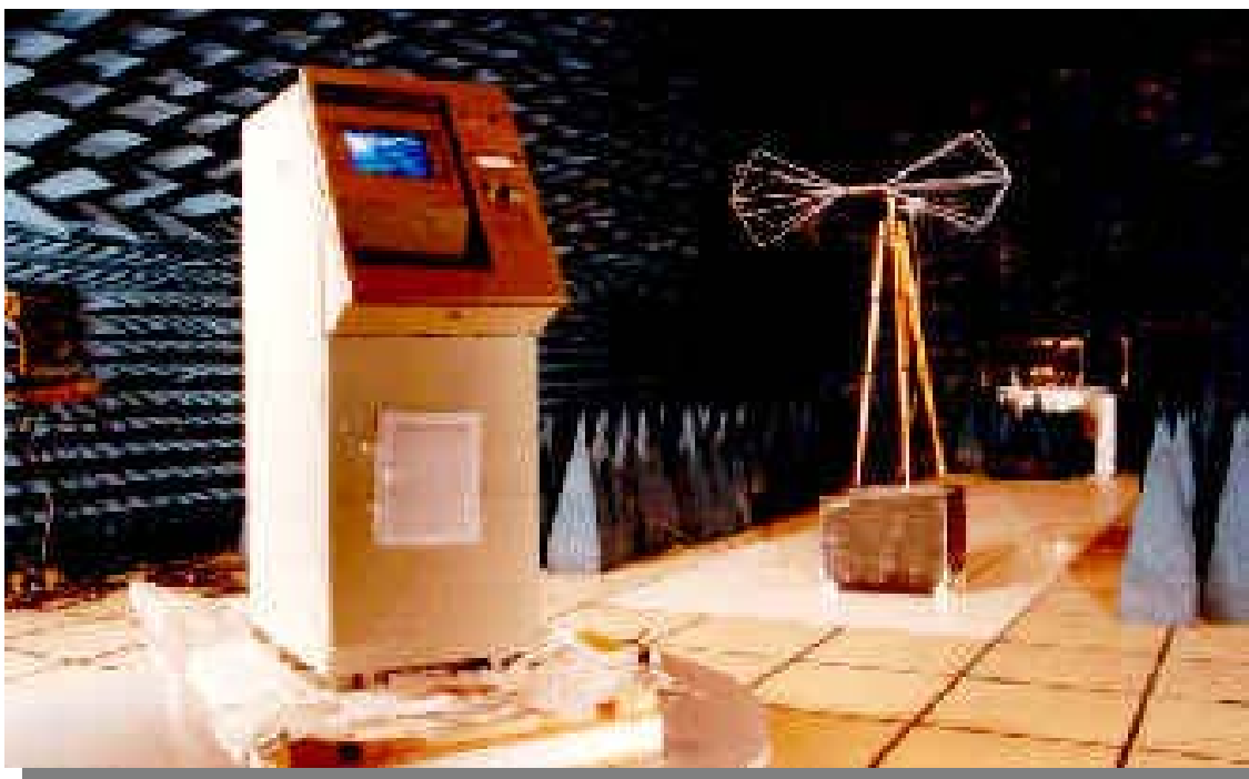
Teste de Compatibilidade Eletromagnética de equipamentos em Câmara Anecóica
